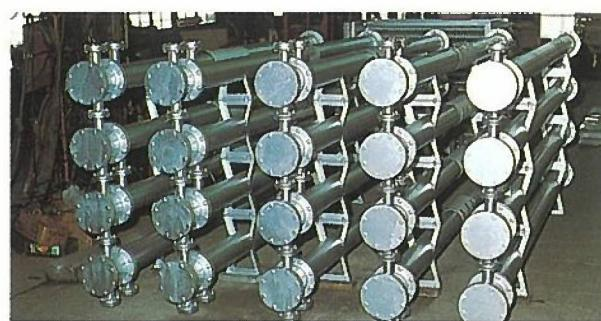
■温廃水熱回収熱交換器
