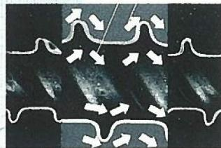
管内のらせん状流路は旋回流を伴う乱流促進効果により境界膜も薄くし、著しく管内熱伝達率を向上させます。また、管外流路においても管群平行流、直交流共特異な形状が優れた乱流効果を示し総括伝熱係数の倍増に寄与します。なお、凝縮や沸騰伝熱面においても滴状、核沸騰効果も作用して高性能です。
