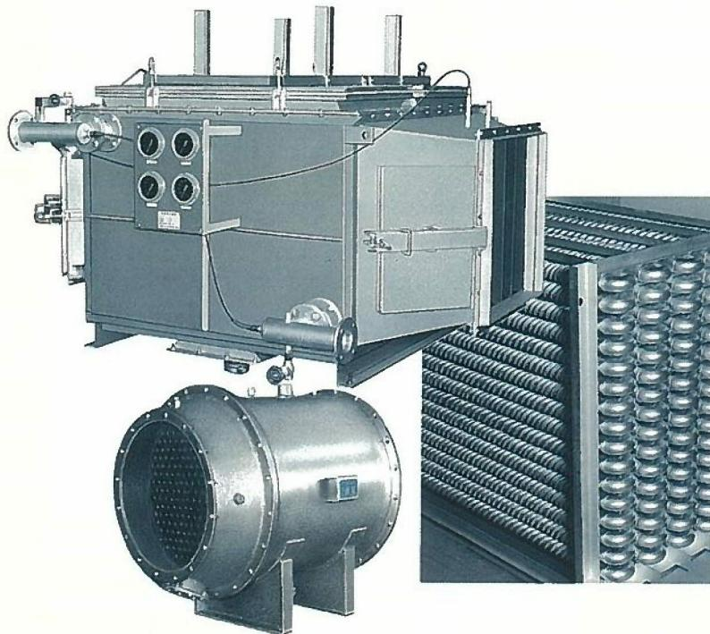
主に、エコノマイザー、温水ヒーター、熱媒ヒーターとして、各種廃ガスからの熱回収用に巾広く利用され高い省エネ効果を上げております。チューブユニットは交換容易なカートリッジ式でダーティガス用途にも充分考慮され、ダスト除去等のメンテナンスも簡単に行えます。
